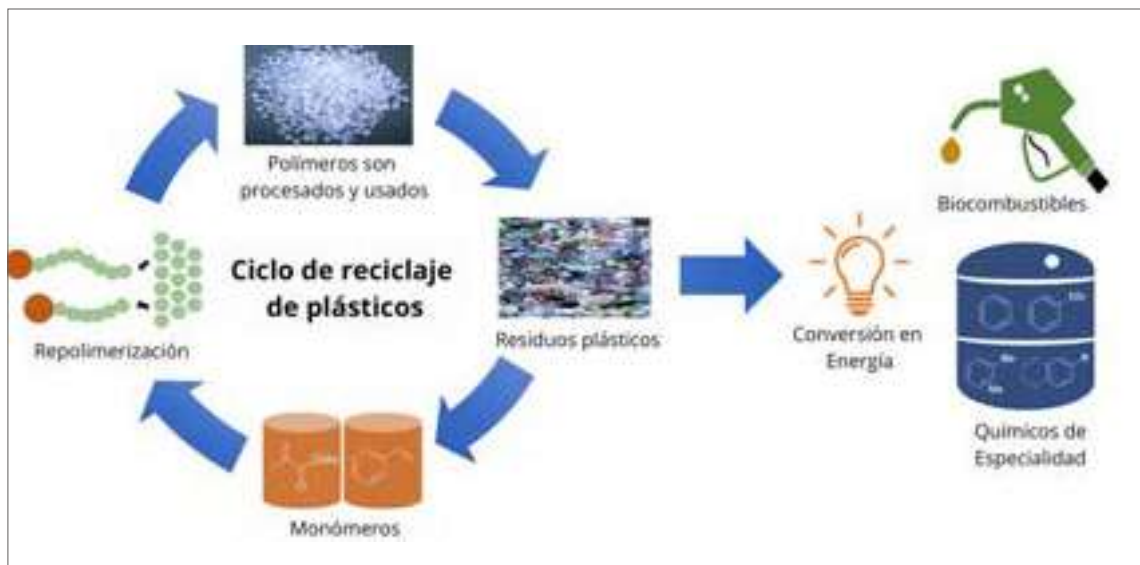
Figura 1. Proceso general de reciclaje químico de plásticos y la opción de tratamiento con pirólisis, generación de energía o producción de químicos especializados (basado en Baranski 2021).
