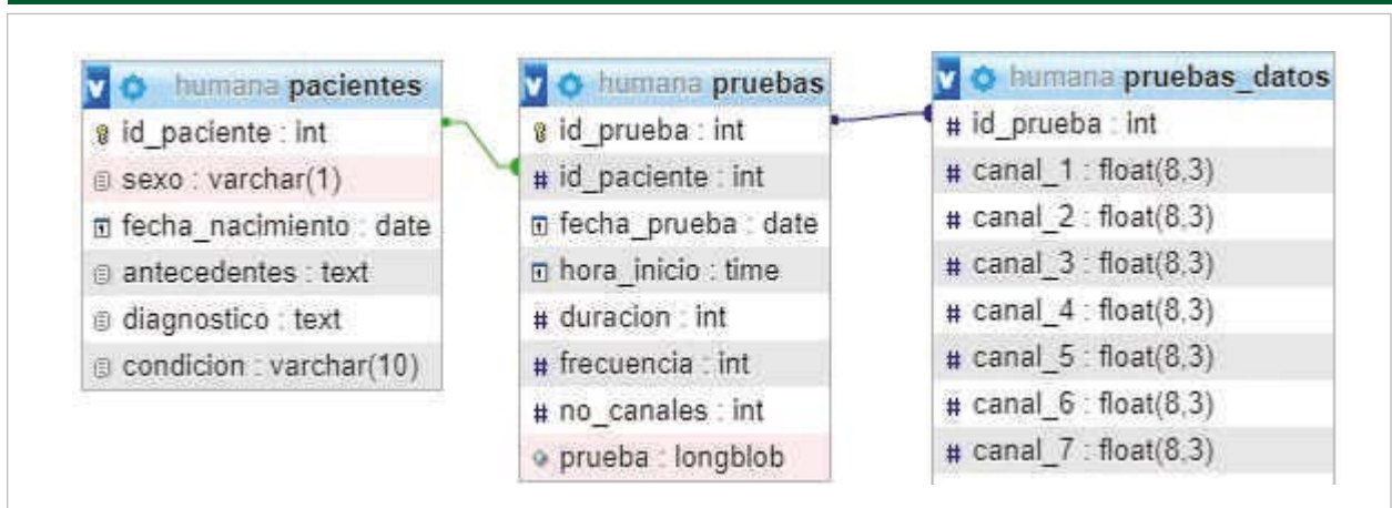
Figura 3. Diagrama entidad-relación de la base de datos. Cada elemento tiene asociado un tipo de dato. Se observan 7 canales, aunque pueden ser hasta 35.
